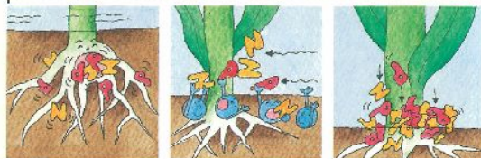
①植物のリン・窒素の吸収による除去 ②底泥の脱着、吸着作用による除去 ③茎との接触による沈殿効果
