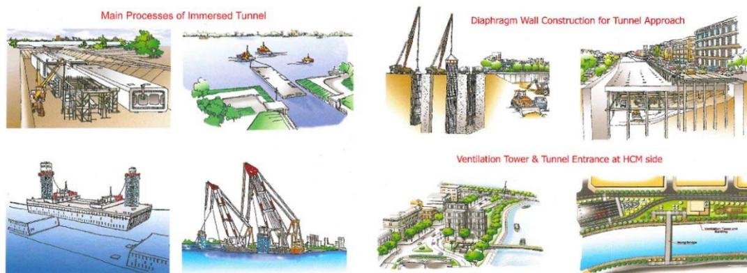
図 3.10 東西ハイウェイの施工状況
