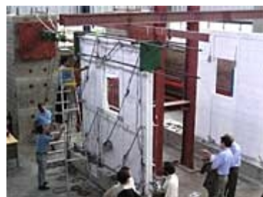
メキシコ・エルサルバドル間のTAISHIN(耐震)プロジェクト(2003年) (耐震普及住宅モデルに関する実証実験)
