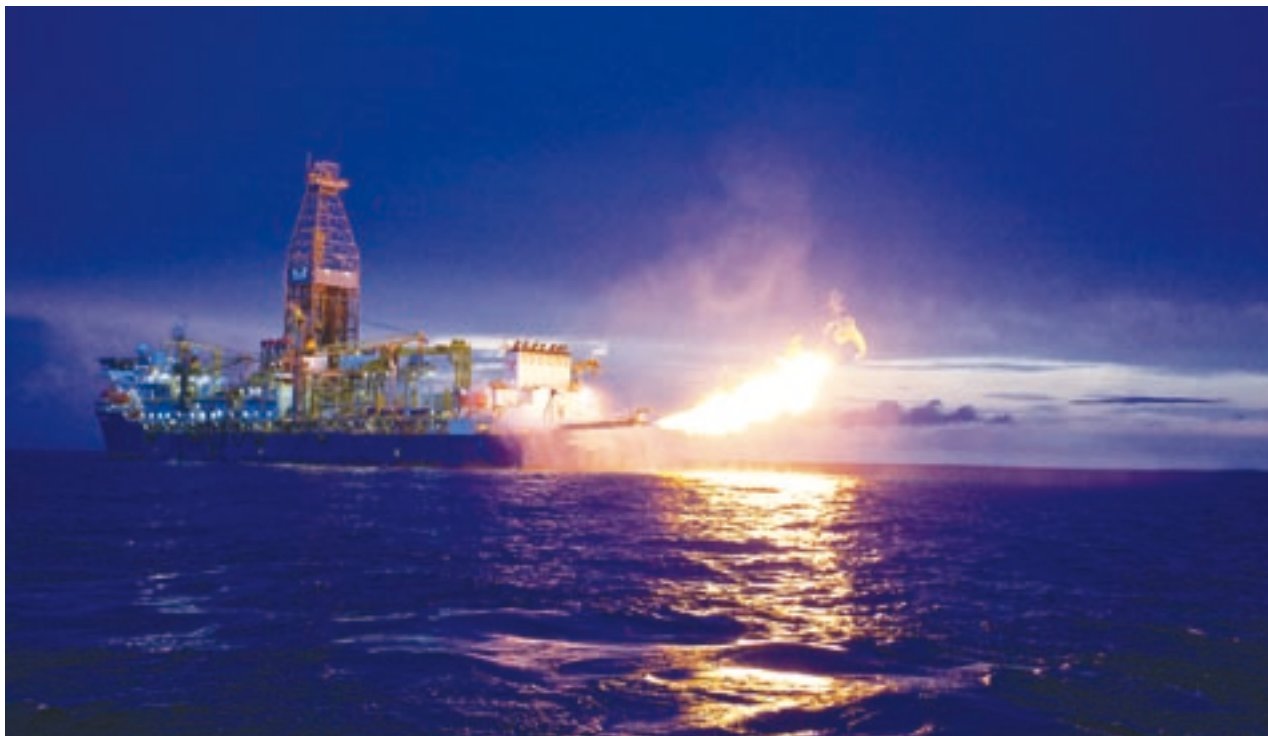
モザンビーク沖の既発見ガス田で生産性のテスト作業を行うドリルシップ（ガス田の探査掘削設備を備えた船） （写真：Anadarko Petroleum Corporation）
