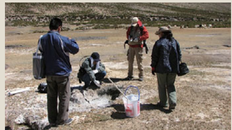
地化学調査（湧水温度測定）を行う日本の調査団とペルー側担当者（写真提供：JICA）
