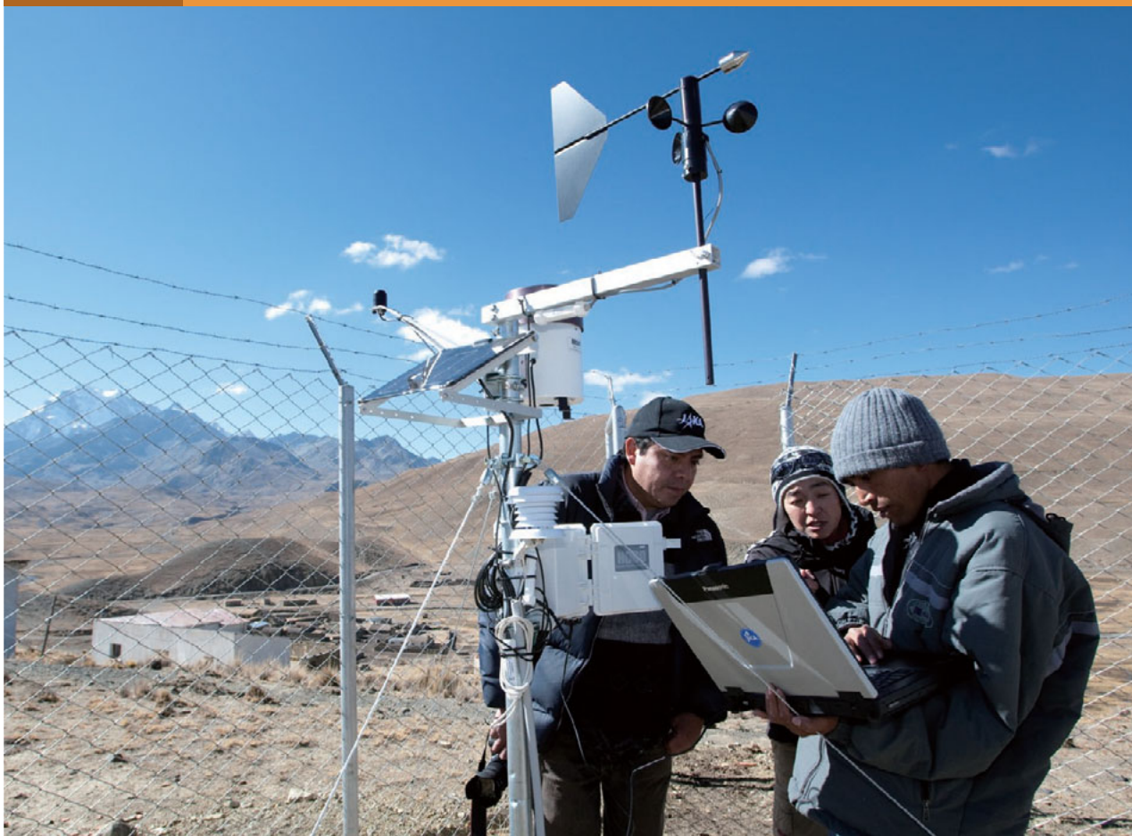
ボリビア「氷河減少に対する水資源管理適応策モデルの開発」ラパス市郊外の観測地点で気象の観測データをパソコンに読み込む日本人専門家とボリビア人技術者(写真提供:久野真一/JICA)
