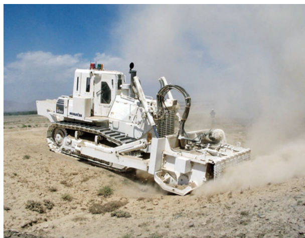
アフガニスタンにて現地実証テストを実施した対人地雷除去機 (写真提供：コマツ)
