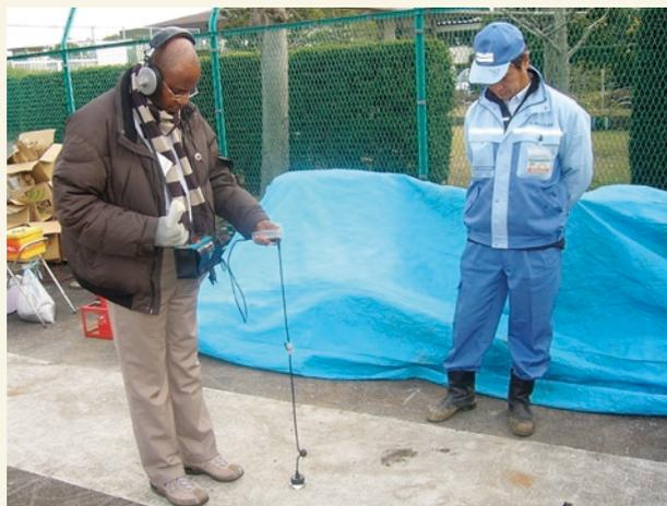
漏水探知機による調査実習(写真提供: JICA)
