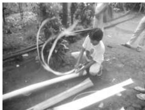
写真 2 アバカの樹木からフィラメント（繊維）を取り出す工程
