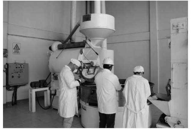
エル・セイボのカカオ加工工場。焙煎、粉碎、圧搾などの加工機械がパイプラインでつながれている
