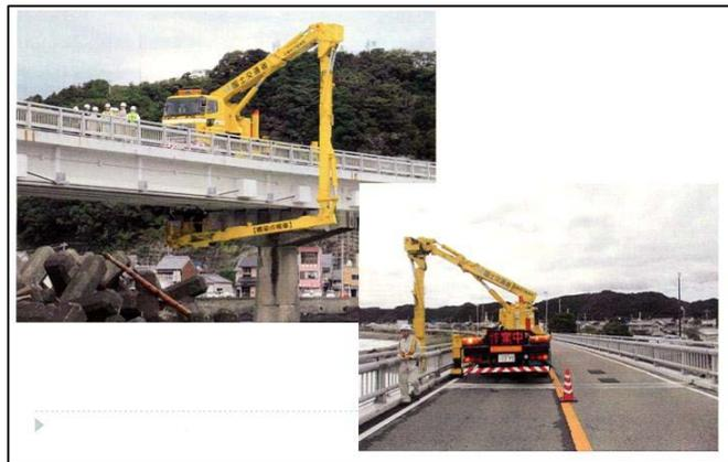
図 3-1 X線を利用した橋梁の非破壊検査<sup>82</sup>
