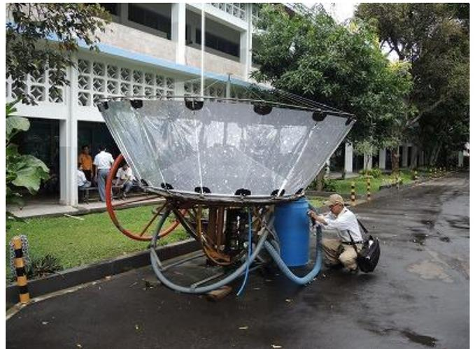
図 2-17 Akademi Teknik Mesin Industri Surakarta の生産施設（左）と、自社開発の太陽熱型スターリングエンジン発電設備（右）
