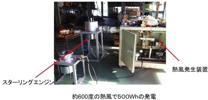
図 2-3 K 製作所 排熱発電試験の様子
