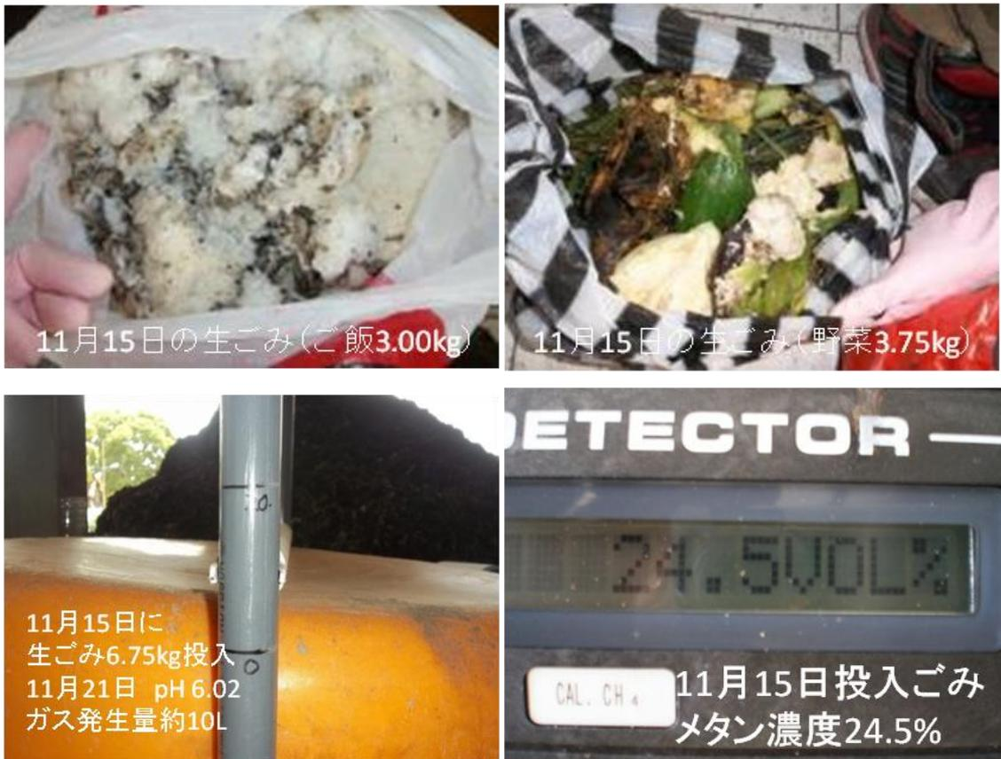
図 34 レストラン系生ごみの発酵実験 1
