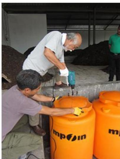
バイオガス製造装置作成
