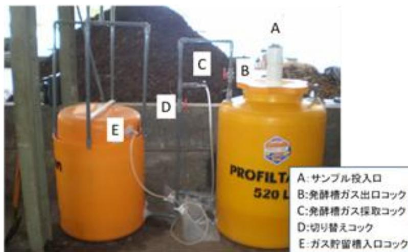
図 26 無加温式メタン発酵装置の現場実物設置の様子
