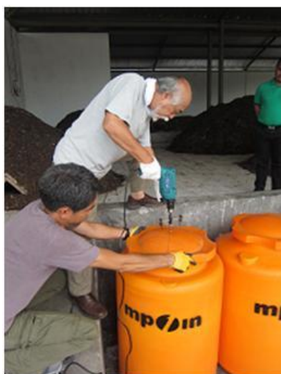
バイオガス製造装置作成
