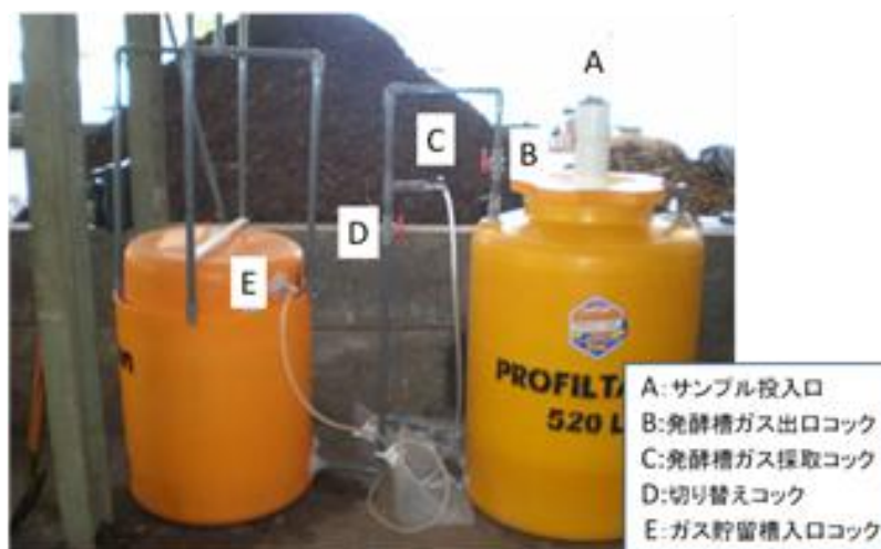
図 26 無加温式メタン発酵装置の現場実物設置の様子
