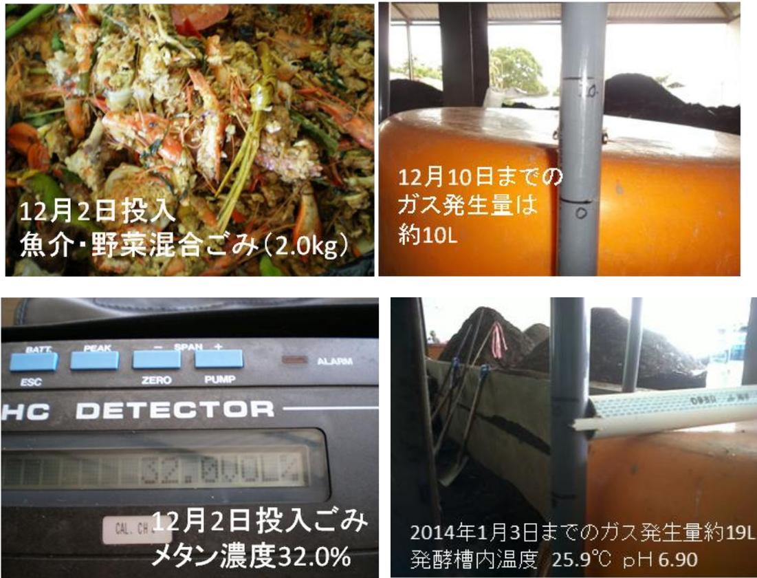
図 35 レストラン系生ごみの発酵実験 2
