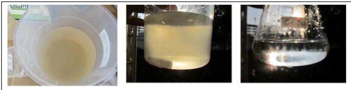
写真. 左より原水、凝集水、ろ過水
