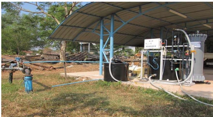
写真. 除マンガン通水テスト装置
