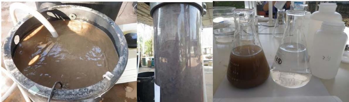
写真. 高濁度模擬原水1000度、左:原水槽 中央:上向流AFによる捕捉状態 右:原水と処理水
