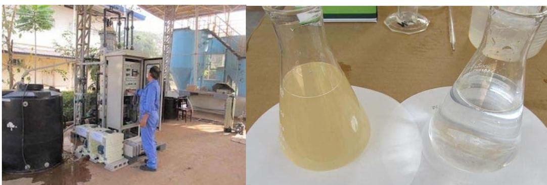
写真. AFテスト装置と原水(濁度67度)、処理水(濁度0.2度)
