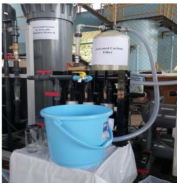
写真. 活性炭通水テスト装置(右側パークタンク)
