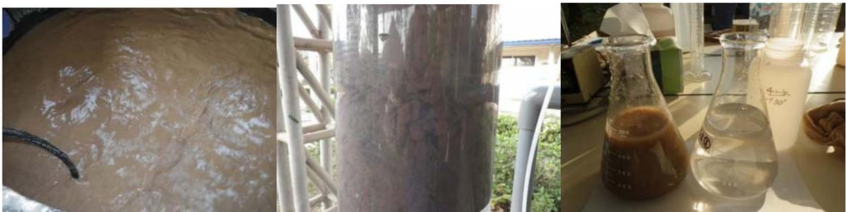
写真 高濁度模擬原水3000度、左:原水槽 中央:上向流AFによる捕捉状態 右:原水と処理水
