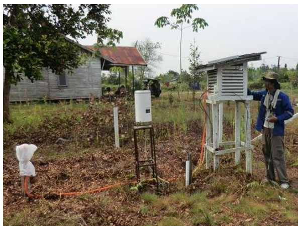
写真3 泥炭地に設置された SESAME システム 雨量計と水位計を接続（温度計は内臓）
