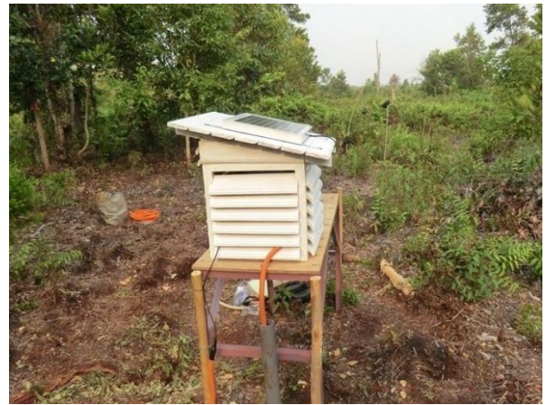
写真2 SESAMEシステムは屋根に設置の 小型ソーラーパネルで作動
