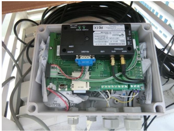
写真1 SESAMEシステムの内部構造 野外用に防水が施されている
