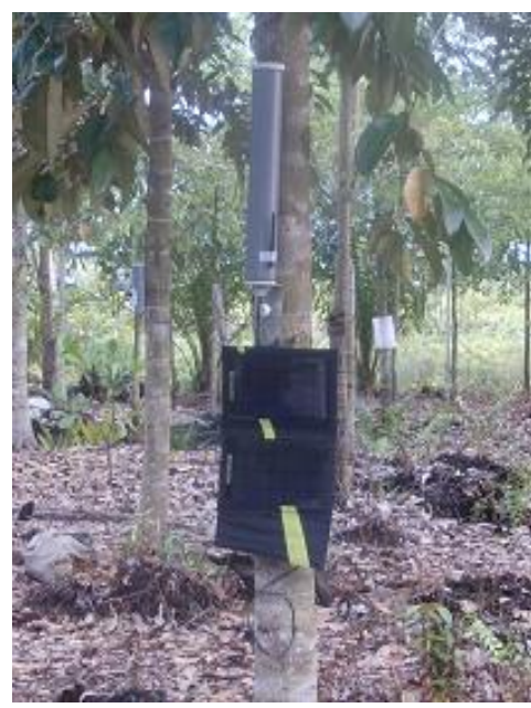
SESAME III システム子機 こちらはデンドロメー タが接続され、近辺に設置された親機と無線接続
