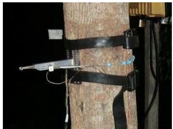
写真4 デンドロメーター 樹木の周長を計測
