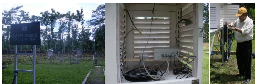
写真 左から、ICCRI の気象観測圃場、SESAME を収納した百葉箱、土壌水分センサー
