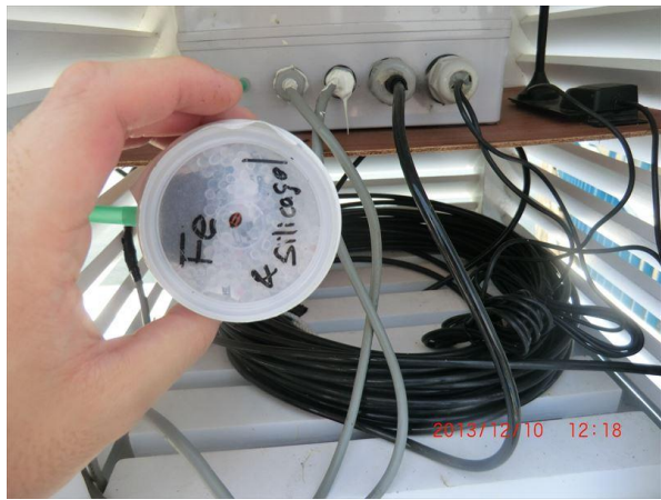
吸収量が多いため、シリカゲルや鉄粉は外部にも付帯させる
