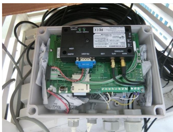
ダムにおける湿気や硫化水素対策として、シリカ ゲルや鉄粉を格納
