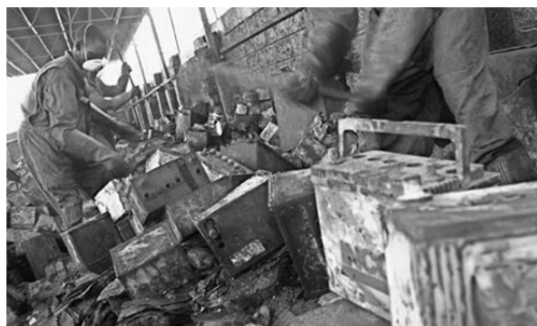
（写真）手作業で廃バッテリーを分解して巢鉛を取り出しているケニアの青年達 5
