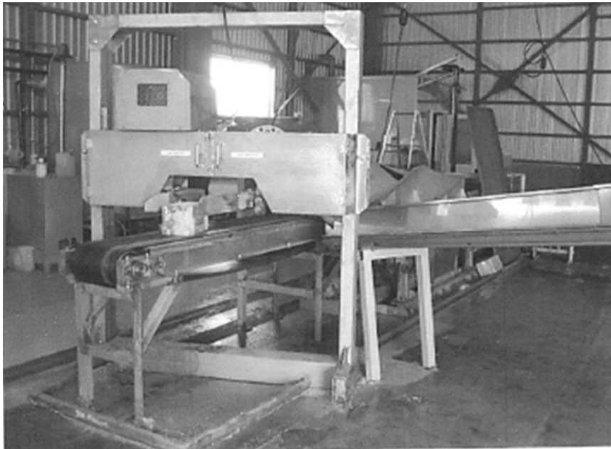
図：ベルトコンベアによる廃バッテリーの切断機 26
