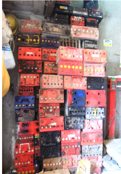
廃酸が抜かれた状態の 廃バッテリー保管場所（屋内）
