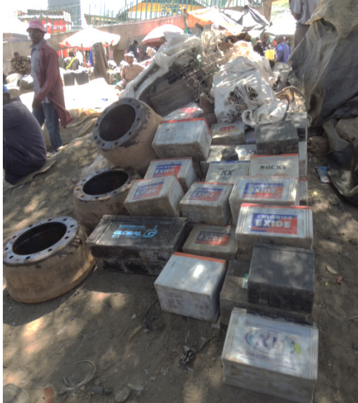
廃酸が抜かれた状態の 廃バッテリー保管場所（屋外）
