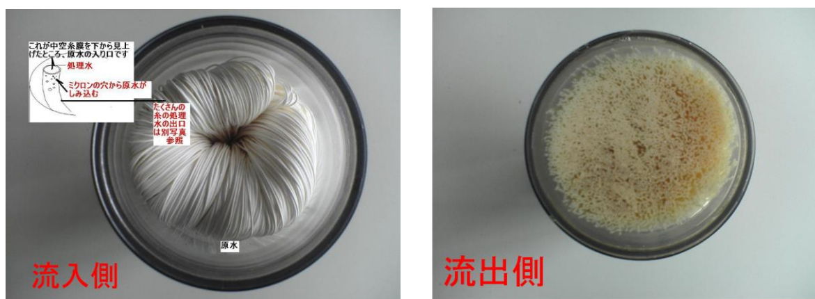
図 2-7：フィルターの構造（縦）
