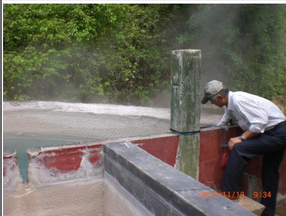
写真 13 源泉貯水槽での水温測定
