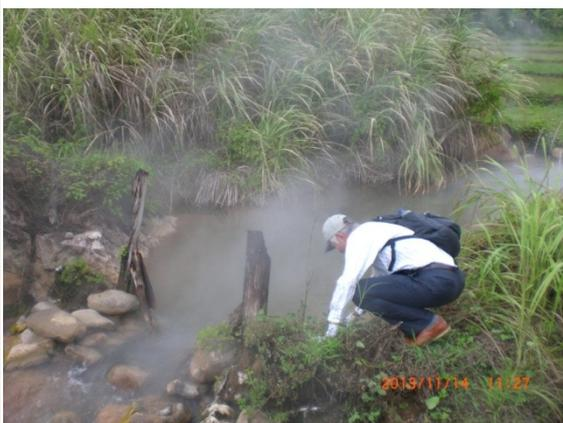
写真 17 熱水源での水温測定
