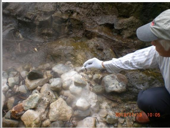
写真 14 河床源泉温度測定
