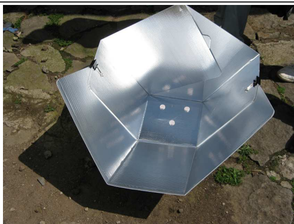
写真 3 組立が完了したソーラークッカー
