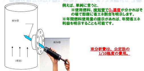
図-1 検知管による揮発性有機化合物の簡易測定イメージ
