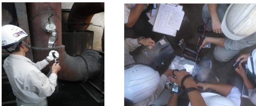
写真 3-3 検知管を用いた排ガス測定
