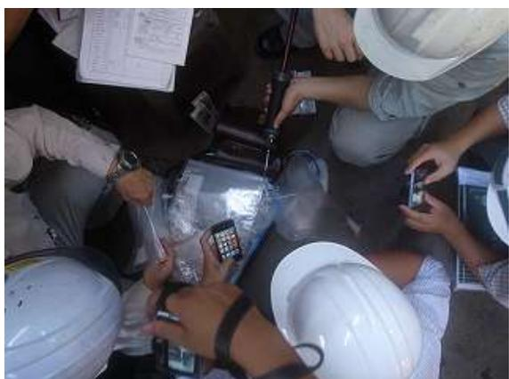
検知管による排ガス濃度確認
