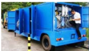
図 2-5 Power Plastic 社の稼動式小型浄水装置
