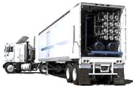
図 2-4 General Electric Company 社の車載式浄水処理装置「MobileFlow® System」
