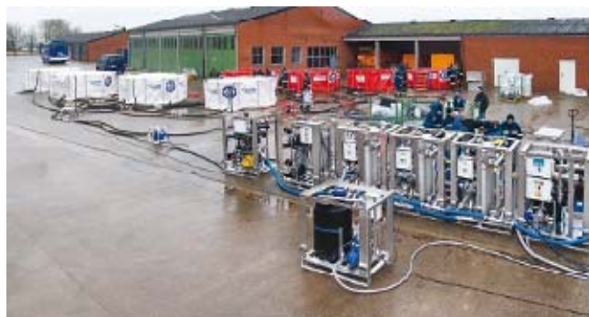
図 2-2 Veolia Water 社のセラミック膜を用いた浄水処理装置「TWA15UF」
