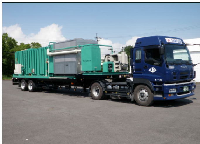
図 6 移動式野菜真空冷却装置の例
