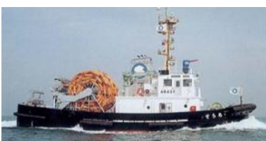
オイルフェンス展張船
