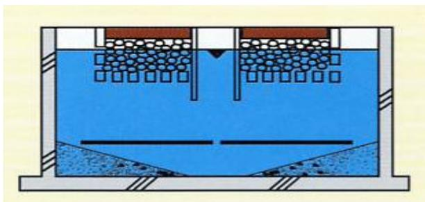
沈殿分離槽は、滞留時間によって、汚泥処理の期間も建設金額も異なっています。一日位の滞留時間が確保されていますが、槽を大きくすれば、汚泥処理の頻度を軽減する事ができます。槽を小さくした場合は、汚泥処理の回数を増やす事が必要になります。
