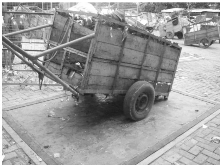
写真 12 計量器(グリーン部分)にて重量を測定中のリヤカー
