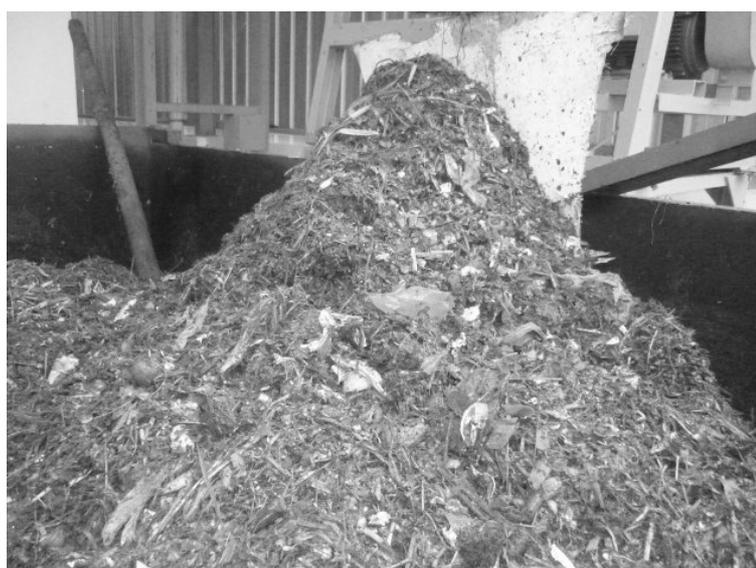
写真 26 コンテナに積み込まれる破碎後の有機ごみ
