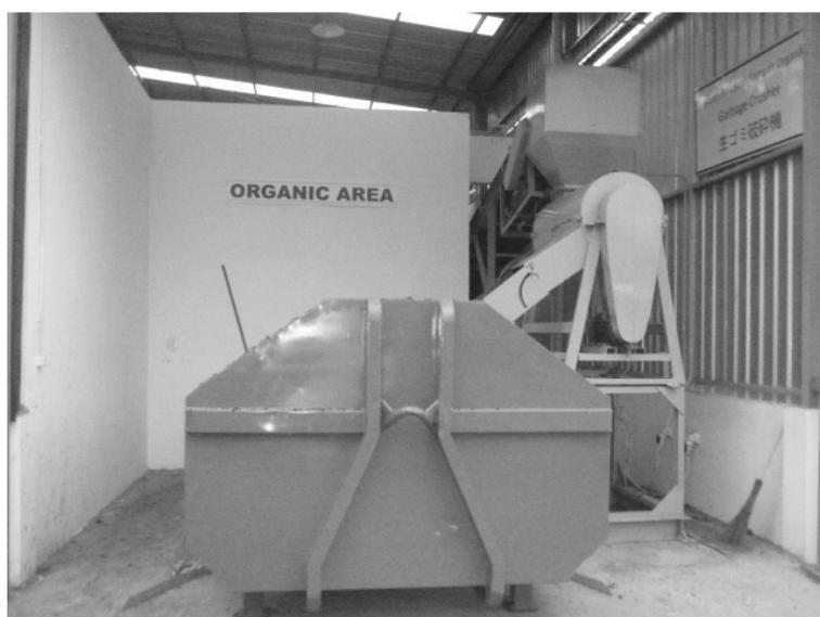
写真 25 生ごみ破碎机（右）と回収コンテナ（中央）
