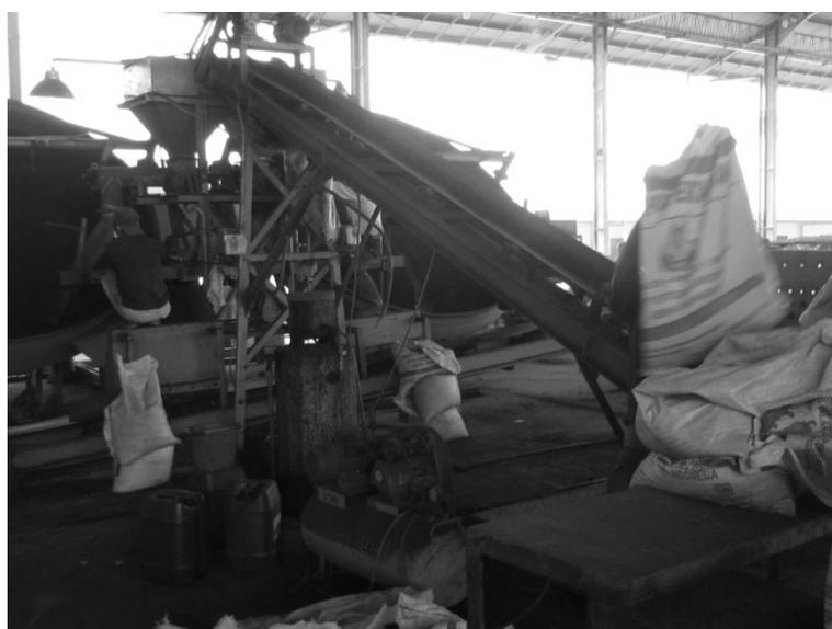
写真 3 コンポスト材料に造粒剤などを混ぜ合わせ、有機肥料を製造する製造工程
