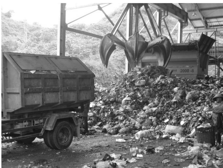
写真 1 一般ごみを、前処理せずにコンポスト製造ラインに投入する
