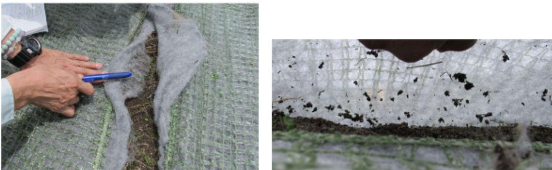
写真 3-1-2-2 シートを剥いだ状態（左）及びシートと地面の密着状況（右）
