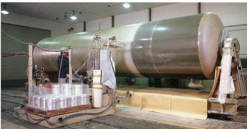
図 2-2 スプレーアップ工法
