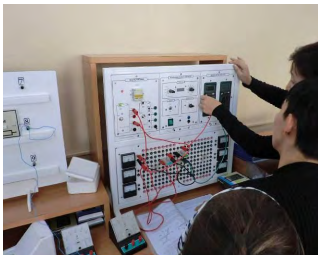
図 3-1 リレーシーケンスの実習パネル（基礎実習用） 69
