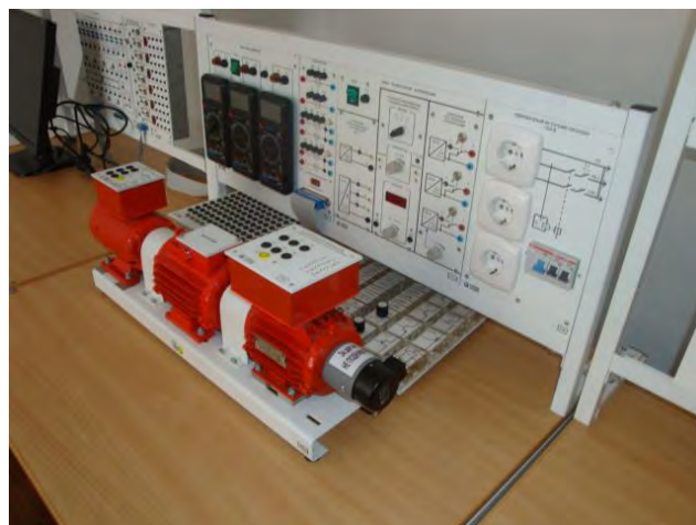
図 3-2 電動機制御実習装置（基礎実習用） 70
