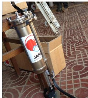
日本の緊急援助で配布された手押し浄水ポンプ。ホースの先から水を吸い上げてタンクの上から浄水が出てポリタンクに入れる仕組み。
