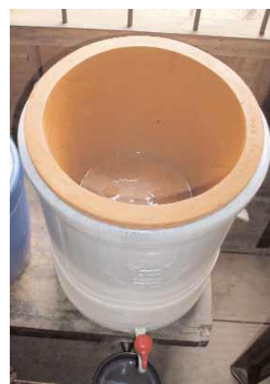
カンボジア国3社で製造されているセラミックフィルター。2002-2006年のユニセフのパイロットプロジェクトで効果が確認された。
