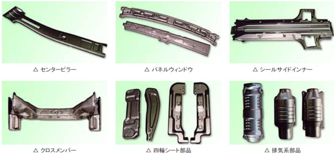
写真2.1 プレス加工による自動車部品の例
