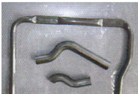
写真2.3 パイプの曲げ・潰し加工品
