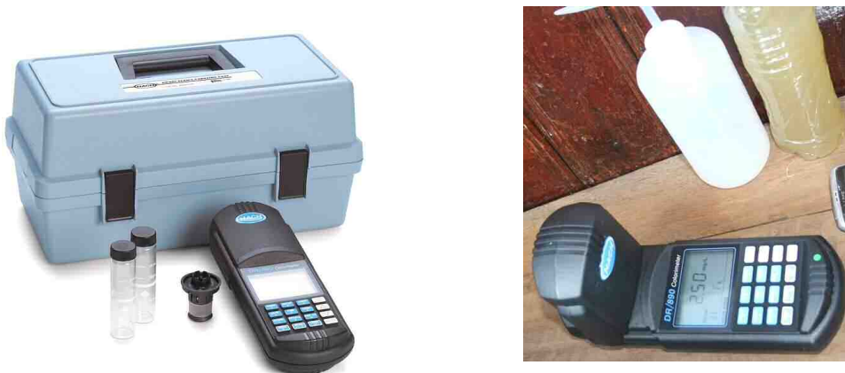
図 1.6.3.18 Fe, Mn 測定用ポータブル水質分析計の概要
