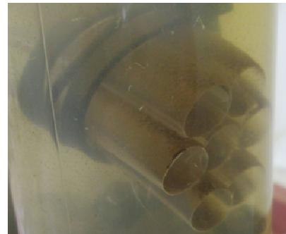
写真 2-1-37 傾斜管沈降状況
