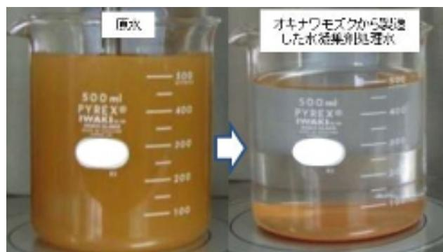
モズクは沖縄の海に生息している生物であり、フコイダンを製造した残渣（一種の廃棄物）から得られる水凝集剤を、高濁度の原水を清浄化させるには最適の材料の一つである。（以上：琉球大学 HP より転用）
