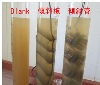
写真 2-1-35 沈降試験 (30 分後)
