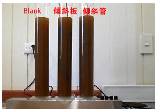
写真 2-1-34 沈降試験 (開始時)
