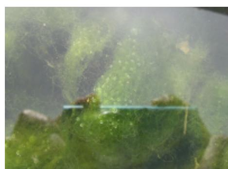
写真 2-1-15 砂ろ過槽 酸素発生状況
