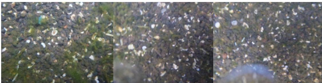
写真 2-1-24 ろ過砂水中写真 (左: 5m/d、中: 10m/d、右: 20m/d)
