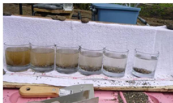
ろ過砂を浸漬攪拌し、洗浄水の濁度を測定した結果を図 2-1-12 に示す。
