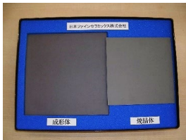
EV普及を支える 絶縁・放熱性能の両立 窒化ケイ素放熱基板
