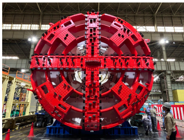
円借款「マニラ首都圏地下鉄計画」において、トンネルの掘削に活用されているトンネルボーリングマシン（写真：三井住友建設株式会社）
