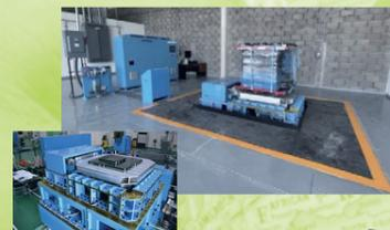
普及・実証事業で導入した振動試験機。自動車部品や精密機器など、デリケートな製品向けの梱包材の耐久試験に不可欠となる。
