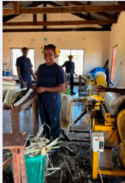
バナナの茎から繊維を取り出す機械を操作する同社の現地スタッフ (写真: JICA)
