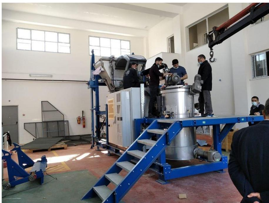
ガザ感染性廃棄物処理施設のマイクロ波滅菌装置据付け作業 (撮影：UNDP)
