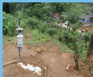
地すべりの前兆を計測するため高台に設置されたばらまき型傾斜計。今日も麓の商店を守っている。
