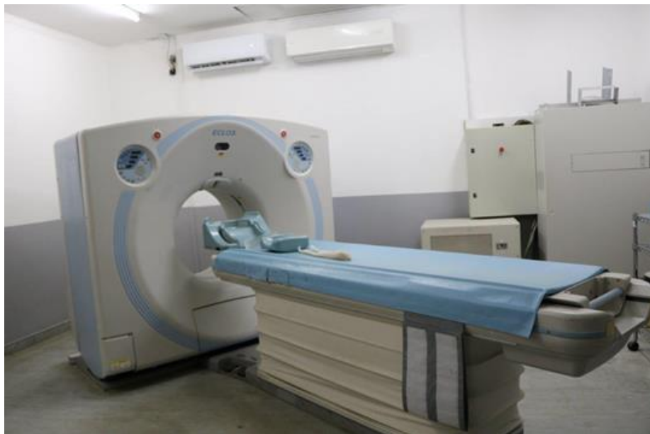
日本製の X 線断層撮影装置（CT）【トアマシナ】 1 度に 4 断面しか撮影できない 4 列式。現在は 64 列式が主流。
