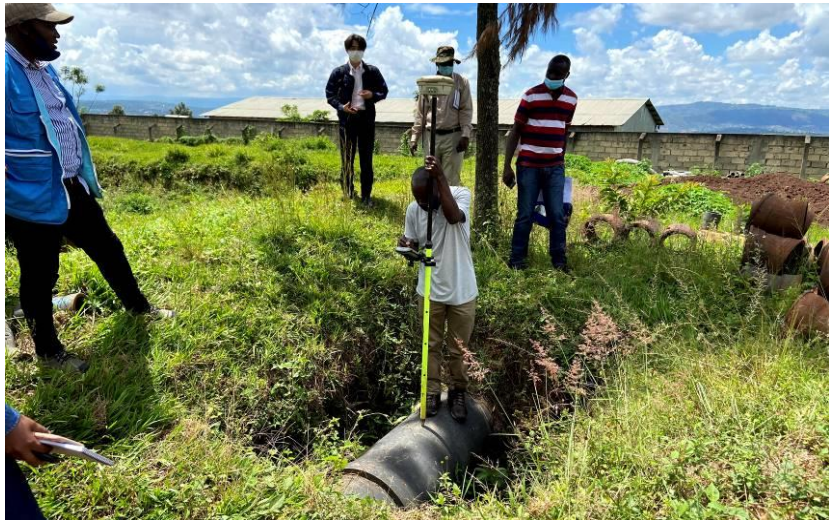
対象地域での管路調査の様子（撮影：マスタープラン調査団）
