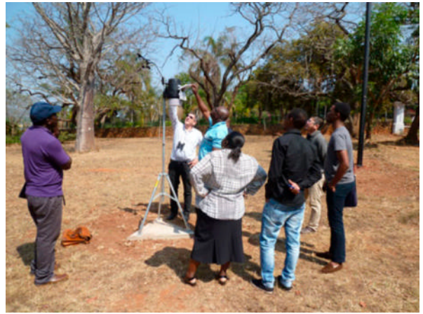
南アフリカにおいて、感染症流行の早期警戒システムの構築プロジェクトにより設置された自動気象観測装置を点検する様子（写真：JICA）
