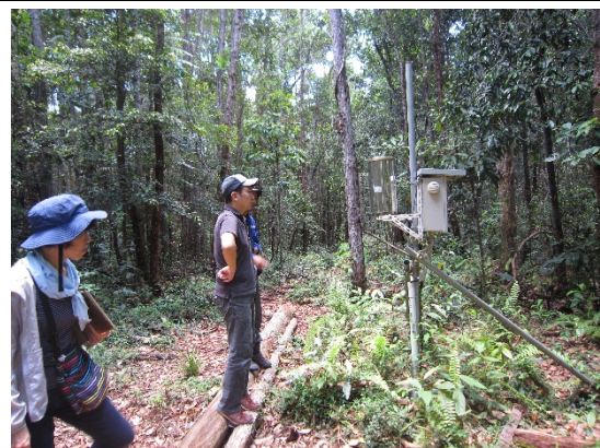
泥炭地の降雨量観測のために設置された SESAME システム(カリマンタン)
