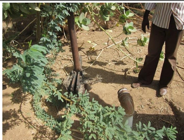
エンジンの仕様に合わず、使われていないアグドゥブ村の水ポンプ
