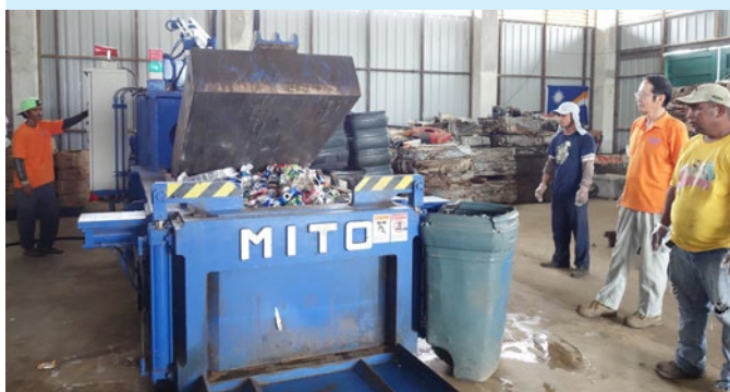
無償資金協力で建設されたリサイクルセンターで廃金属圧縮機を稼働させている様子。右から2人目が富野専門家。(写真提供：在マーシャル日本大使館)
