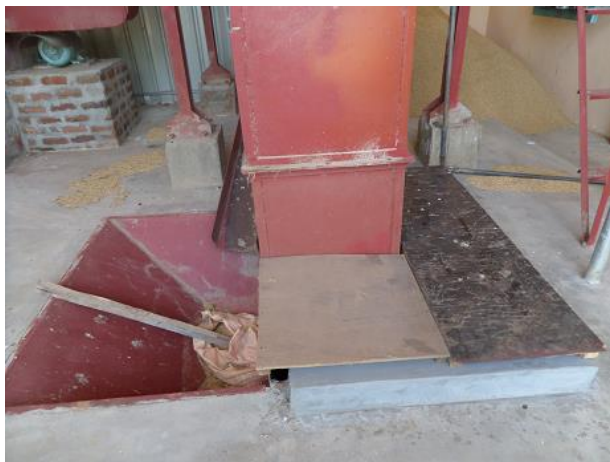
安全対策として稲乾燥機の溝部分を木材でカバ ー (2015年7月9日)
