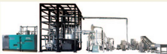
前処理装置と廃プラスチック油化装置の構成（写真：㈱CFP）
