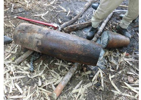
落下時の衝撃により不発弾が変形し切断面がゆがんだ状態になる場合は通常より多くのカット時間を要する。
