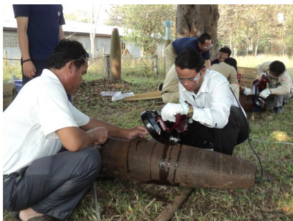
電気のこぎり(ローターバンドソー)を使用して爆弾カットの練習を行う訓練センター教官
