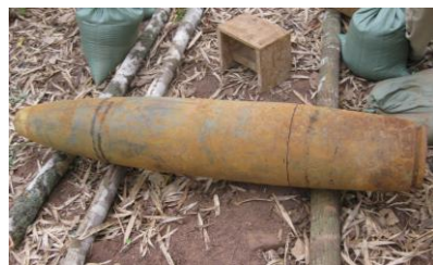
のこぎりカット法により処理を 行う信管付500ポンド爆弾
