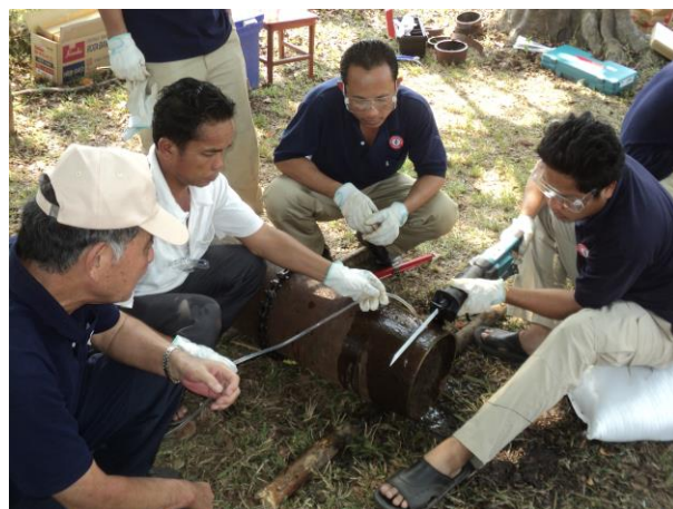
電気のこぎり(レシプロソー)を使用して爆弾カットの練習を行うSEOD
