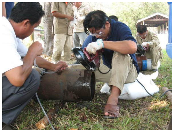
電気のこぎり(ローターバンドソー)を使用して爆弾カットの練習を行うSEOD
