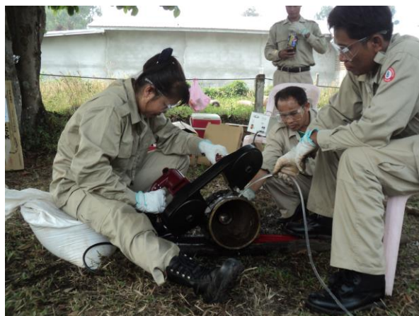
電気のかぎり(ローターバンドソー)を使用して爆弾カットの練習を行うチームリーダー
