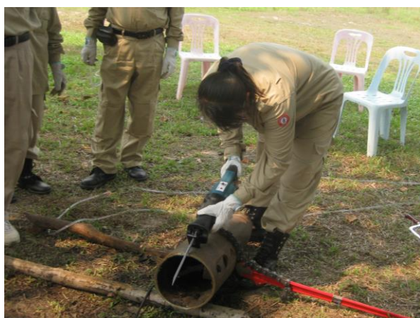
電気のかぎり(レシプロソー)を使用して爆弾カットの練習を行うチームリーダー
