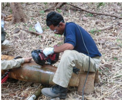
信管付爆弾の爆弾カットを行う SEOD
