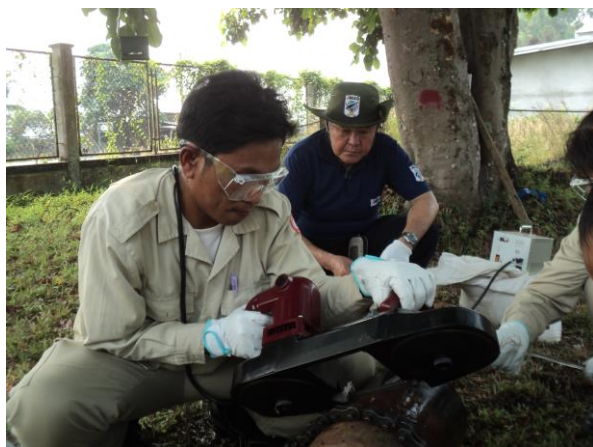
JMAS専門家の指導を受け電気のかぎり(ローターバンドソー)での爆弾カットを練習するチームリーダー
