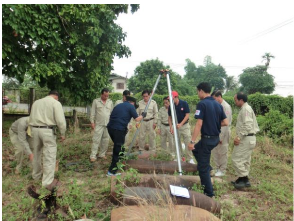
ホイスト、三脚ヘッド、アルクレーンの使用方法についてJMAS専門家から説明を受けるSEOD
